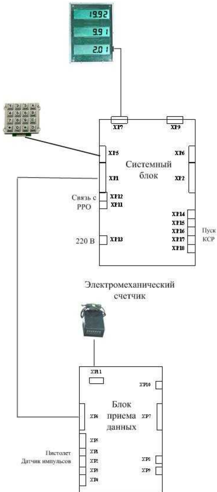
Рис. 5.1.3. Подключение устройства для управления однопистолетной ТРК.
