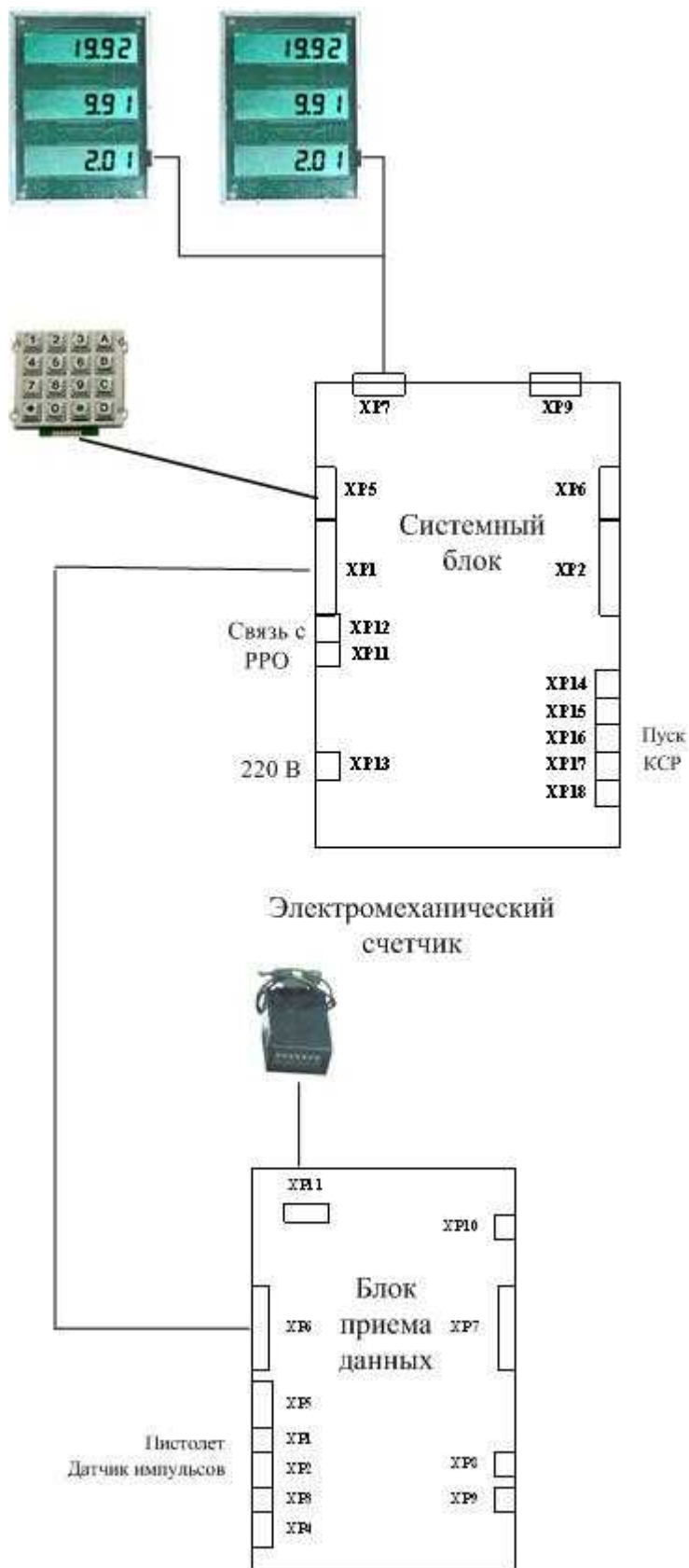
Рис. 5.2.3. Подключение отсчетного устройства для управления однопистолетной ТРК с возможностью отпуска на две стороны.
