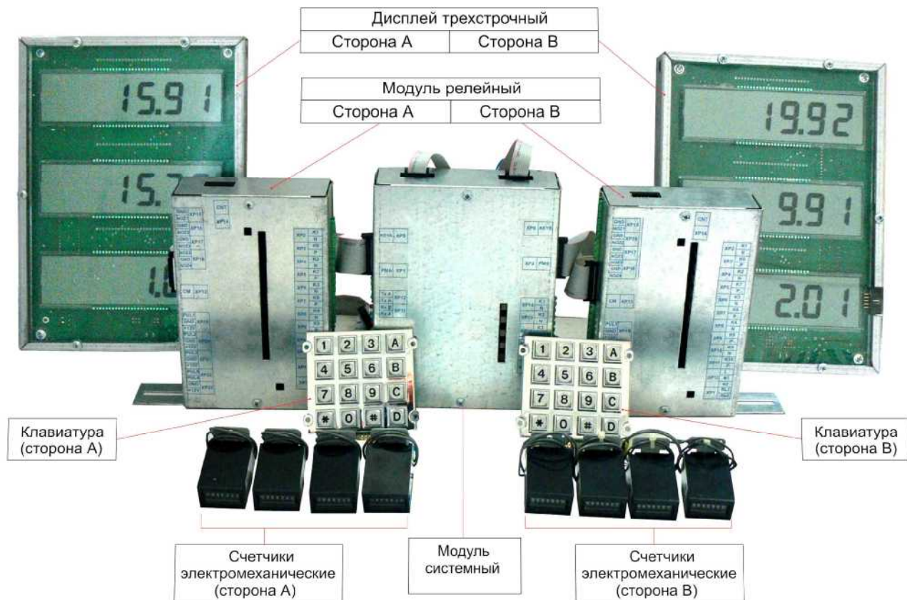
Рис. 5.4.2. Состав отсчетного устройства для управления модульной ТРК.
