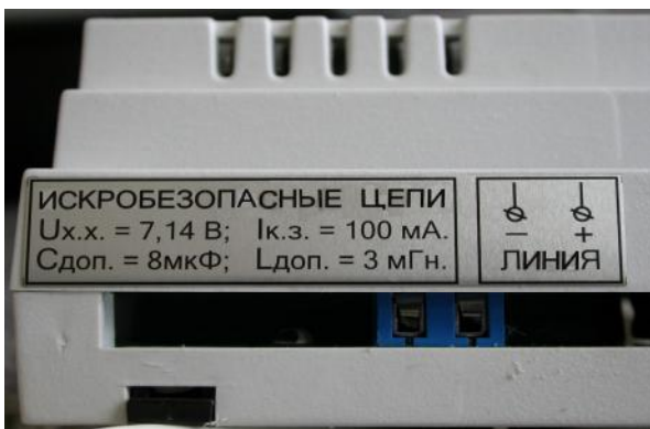
Место подключения датчиков к пульту управления.
