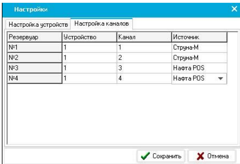
Программа настройки системы НафтаПОС – настройка драйвера системы измерения уровня "ATG Struna-M", вкладка "Настройка каналов"
